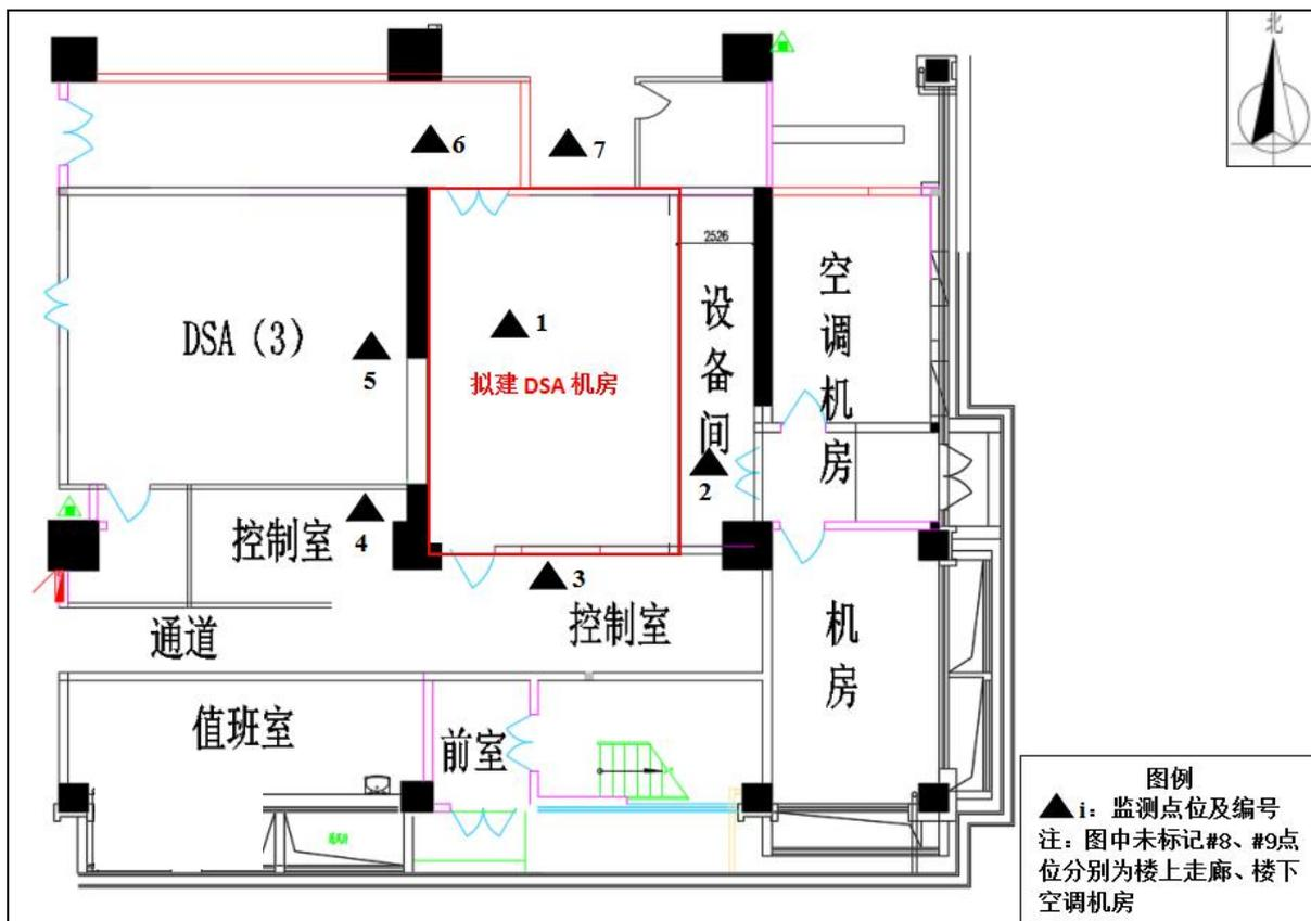
图 8-1 拟建 DSA 机房平面布置及监测布点图
